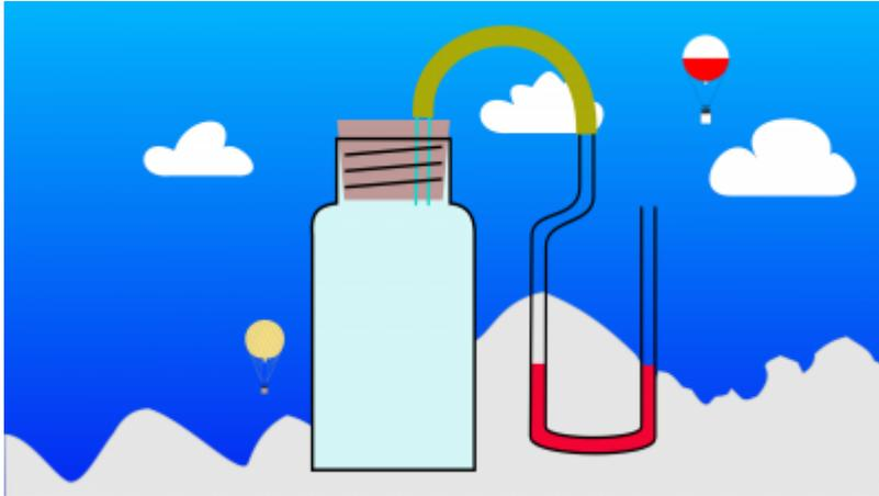
Der U-Rohr-Höhenmesser verwendet zur Druckmessung eine Flüssigkeitssäule. Eine Seite des U-Rohrs ist mit einem Druckbehälter für den Referenzdruck verbunden, die andere Seite des U-Rohrs ist offen, und hier wirkt der Atmosphärische Druck. Die Verwendung einer Flüssigkeitssäule in einem U-Rohr zur Druckmessung wird auch als U-Rohr-Manometer bezeichnet.
