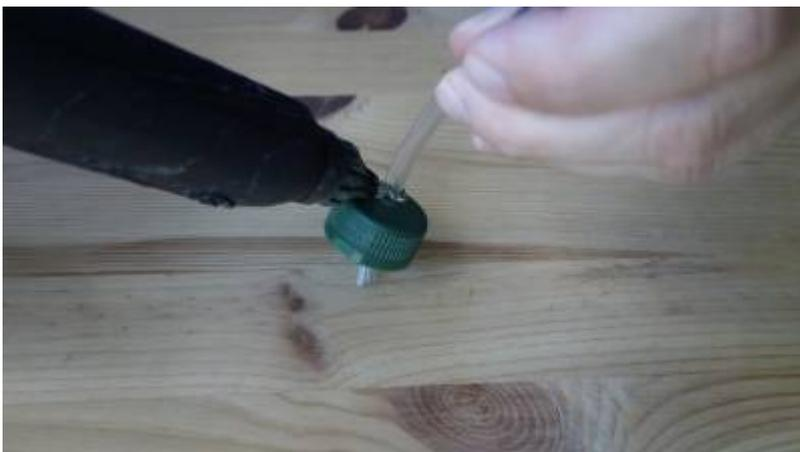
Mit der Heissklebepistole wird die Öffnung außen abgedichtet.
