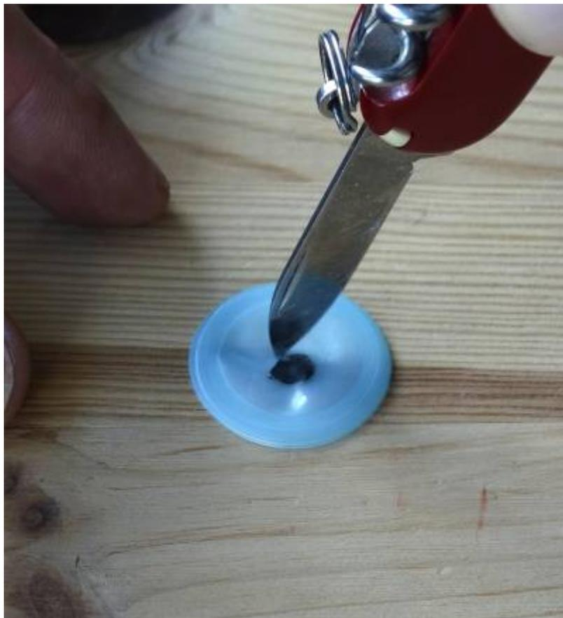
Loch in die Dichtung schneiden.
