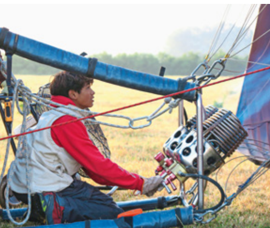
Flugschüler Mael heizt mit dem Brenner die Luft in der Ballonhülle auf
